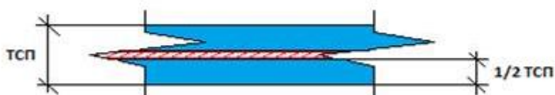
Рис.1 Укладка армирующей сетки
